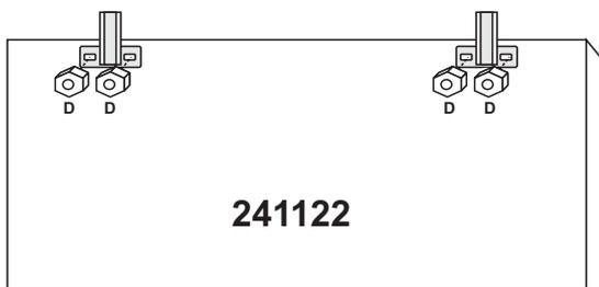
Fixar o calço 12MM dobradiça(F) na peça 241122 usando Parafuso Maq. 4x25(G) junto com Porca Sextavada (D).
