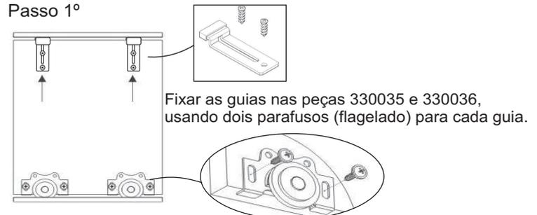
Fixar as roldanas nas peças 330035 e 330036, usando dois parafusos. A fixação desses parafusos deve estar no centro das furações.
